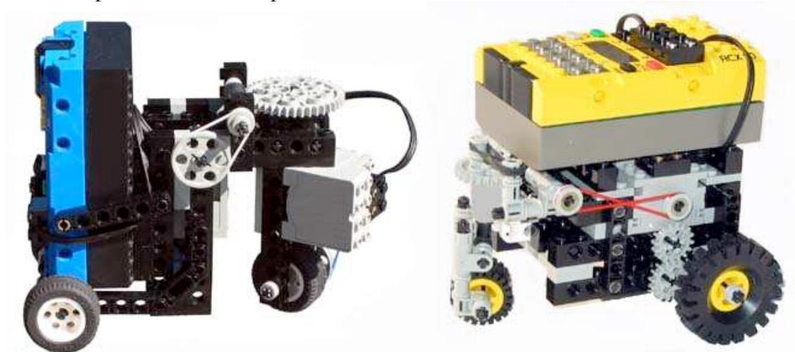
**Illustration 5-16.** Un tricycle (à gauche) et une plate-forme à trois roues à direction frontale (à droite) se ressemblent
